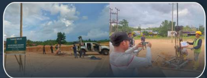
Pengujian tanah sekaligus melakukan survey pemetaan (topografi) guna mengukur atau menakar keadaan lokasi pembangunan
